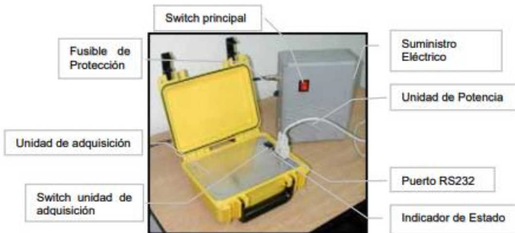
Figura 18 Partes del dispositivo Fuente: [27]
