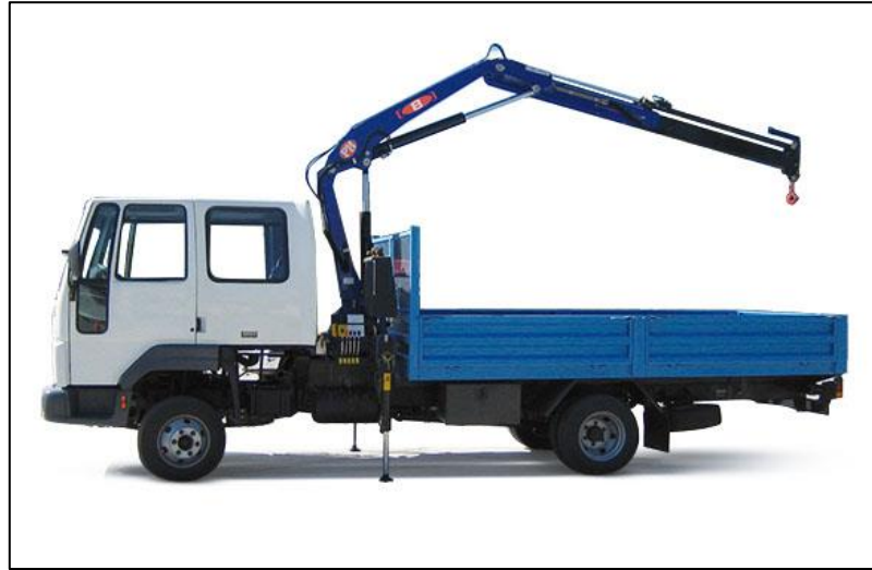
Figura 7: Ejemplo de grúa articulada
