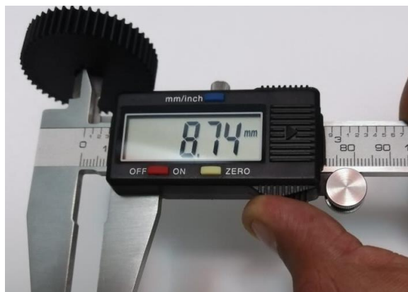
Figura 38. Proceso de medición diámetro del agujero, Fuente: El Autor
