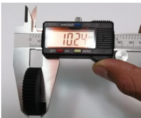
Figura 37. Proceso de medición anchura del engranaje, Fuente: El Autor
