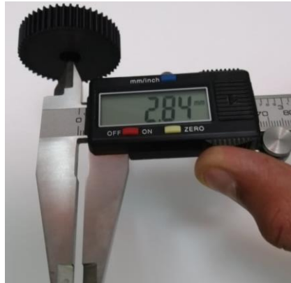
Figura 39. Proceso de medición chaveta, Fuente: El Autor
