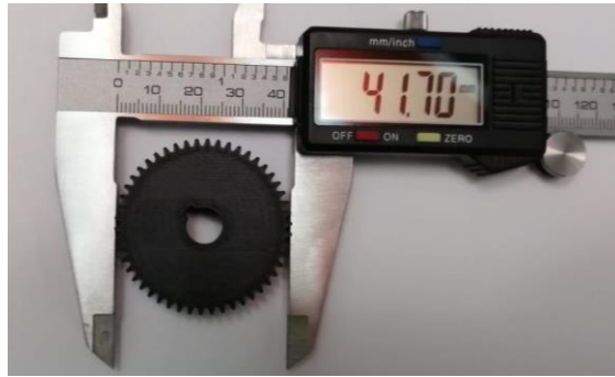
Figura 35. Proceso de medición circunferencia de cabeza, Fuente: El Autor
