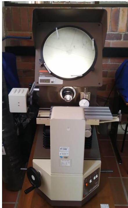
Figura 31. Proyector de perfiles MITUTOYO PH350, Fuente: El Autor.
