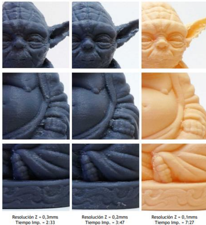
Figura 1. Efecto del espesor de capa. Fuente: [17].
