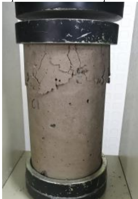
Figura 11. Tipos de fallas en las probetas de concreto Tipo 2.
