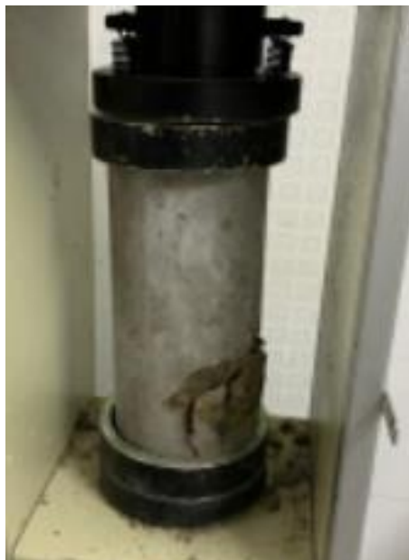
Figura 12. Tipos de fallas en las probetas de concreto Tipo 5.
