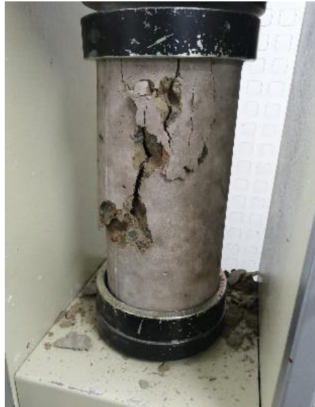
Figura 10. Tipos de fallas en las probetas de concreto Tipo 3.
