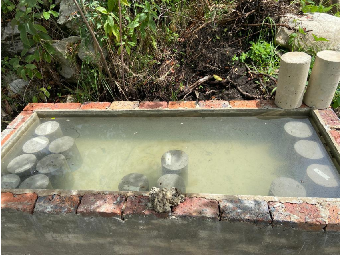
Imagen 15. Piscina adecuada en obra para muestras cilíndricas de concreto.
