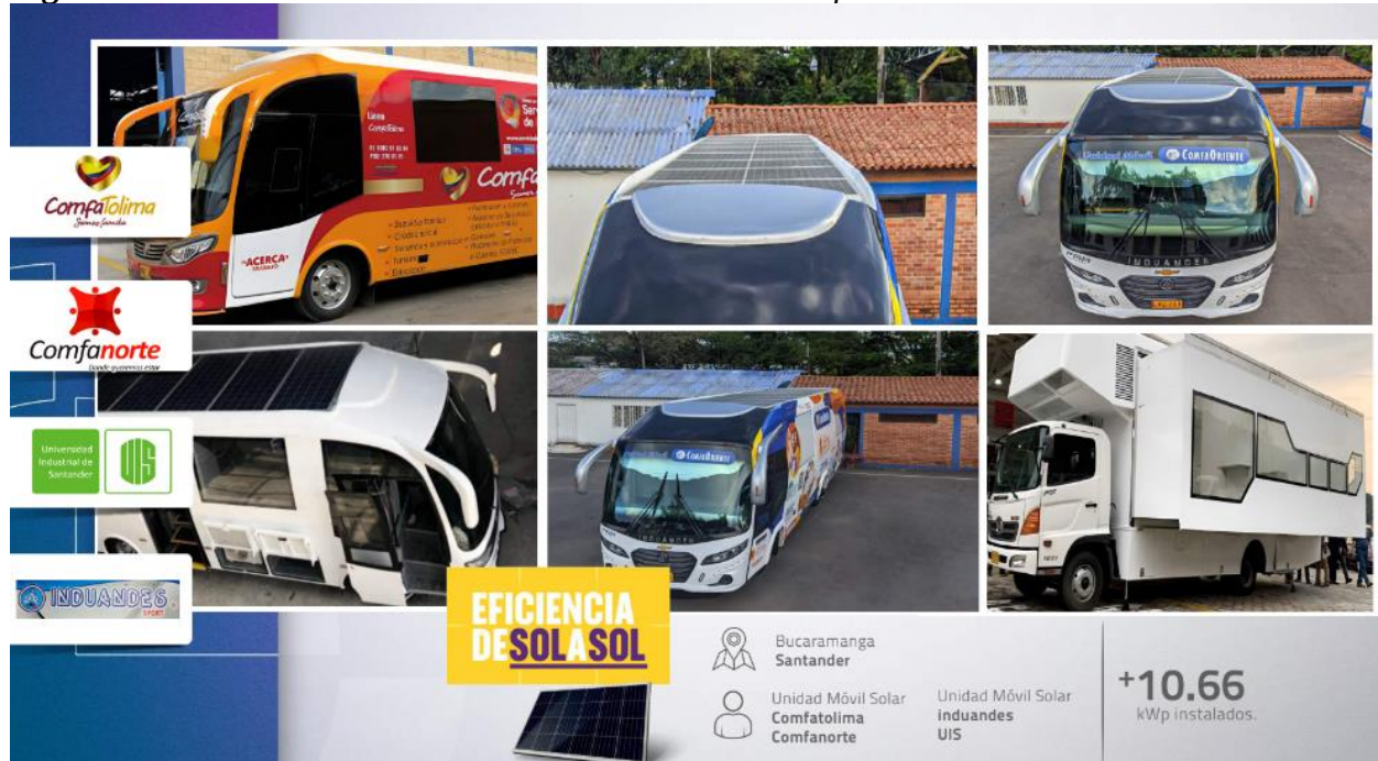
Figura 6. Paneles solares instalados en unidades móviles por GEENERA S.A.S.
