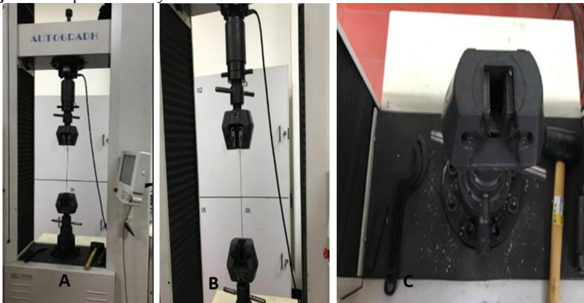
Figura 5. Máquina de ensayo Shimadzu AG-1 250kN
