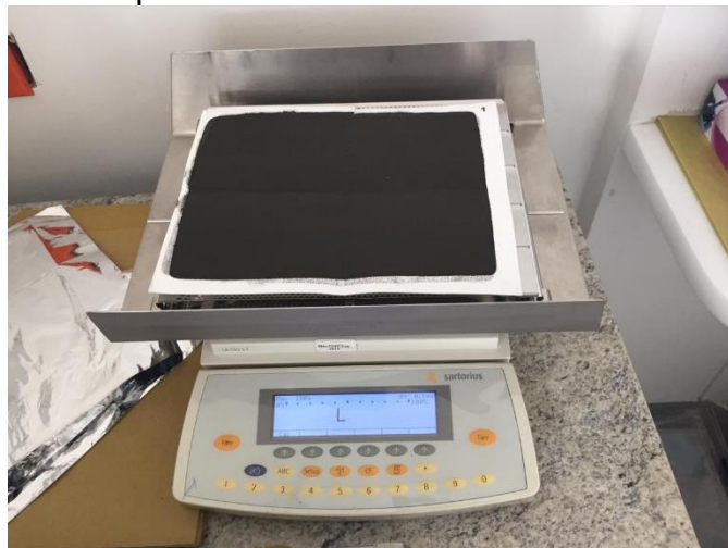
Figura 3-2. Pesaje de filtro impactado en balanza analítica del CTAS
