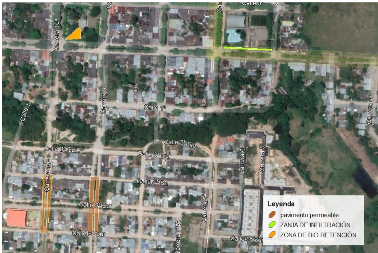
Ilustración 11 Diseño conceptual de SUDS en el municipio de Paratebueno. Fuente: propia (Adaptado de Google Earth)
