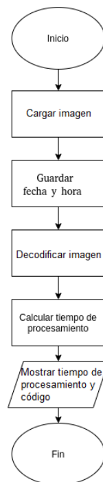
Figura 5.24: Diagrama de flujo para test de librerías de uso libre Fuente: Autor
