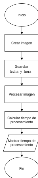
Figura 5.19: Diagrama de flujo para test de tecnologías Fuente: Autor
