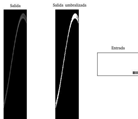
Figura 5.12: Transformada de Hough a código de barras en zona inferior derecha Fuente: Autor
