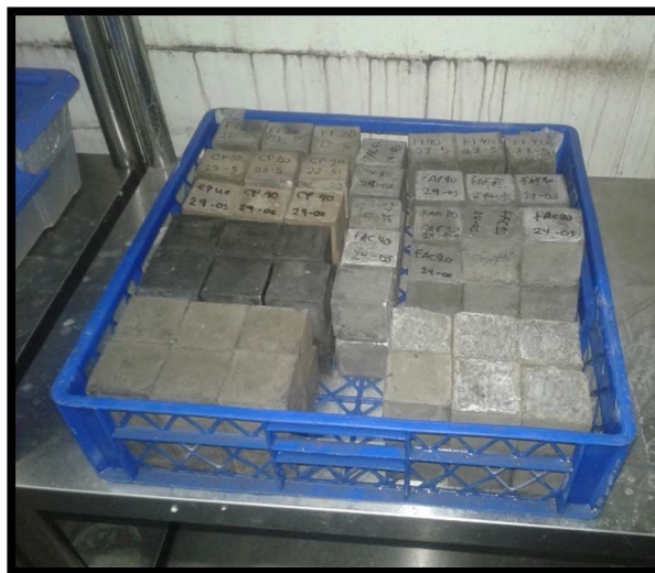
Figura 7.2.1 Pasta de cemento en cuarto de curado a 23°C y HR 100% Fuente: Propia
