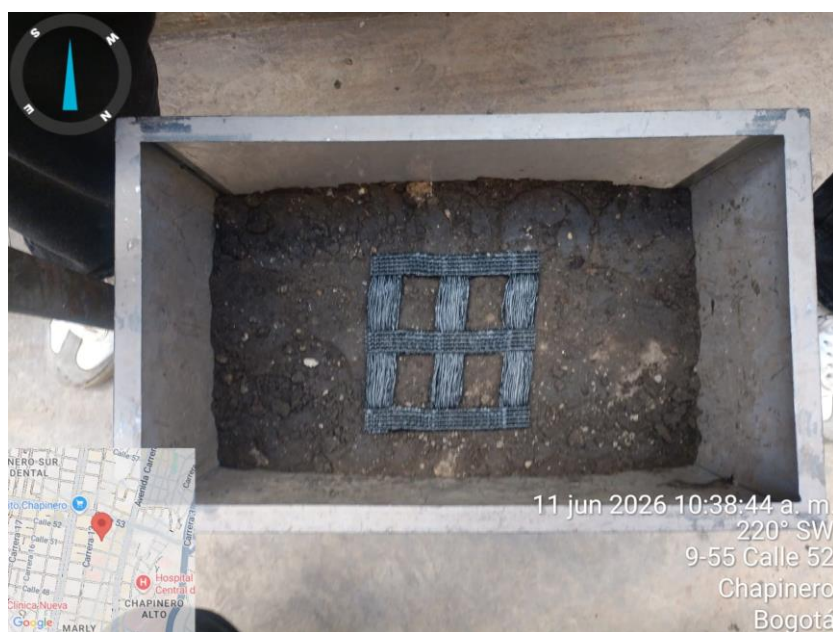
Figura 7. Aplicación geomalla biaxial PET GG100/100
