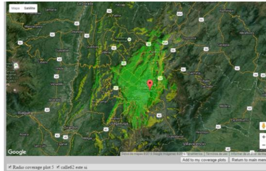
Figura 19. La Antena está ubicada en la sede de la calle 62 y vemos a propagación de la señal, con una visión satelital.
