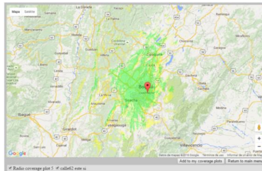
Figura 19.1. La Antena está ubicada en la sede de la calle 62 y vemos a propagación de la señal, con una visión mapa.
