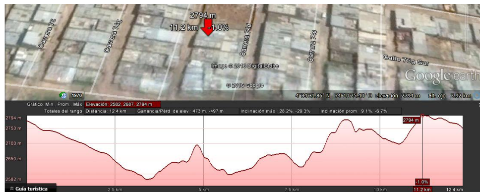
Figura 16. Mostrando el punto donde debería estar la repetidora.
