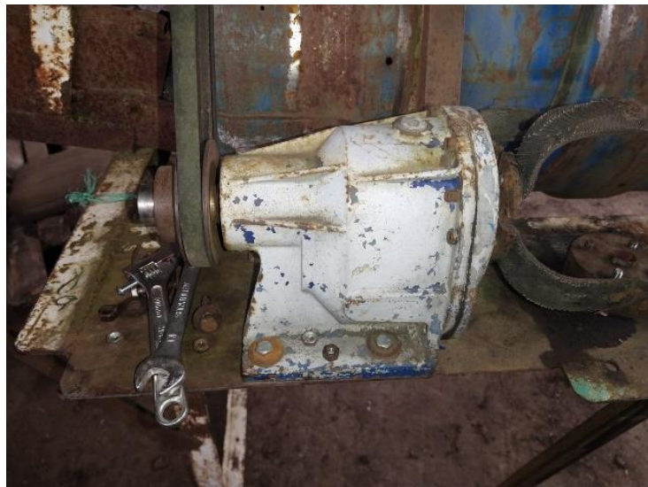
Figura 34 . Reductora 40:1 usado en máquina
