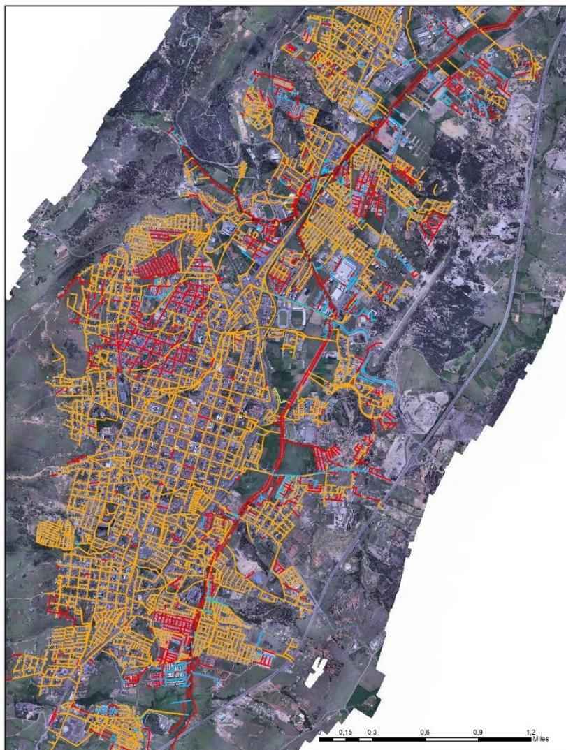
Ilustración 5. Sistema de alcantarillado
