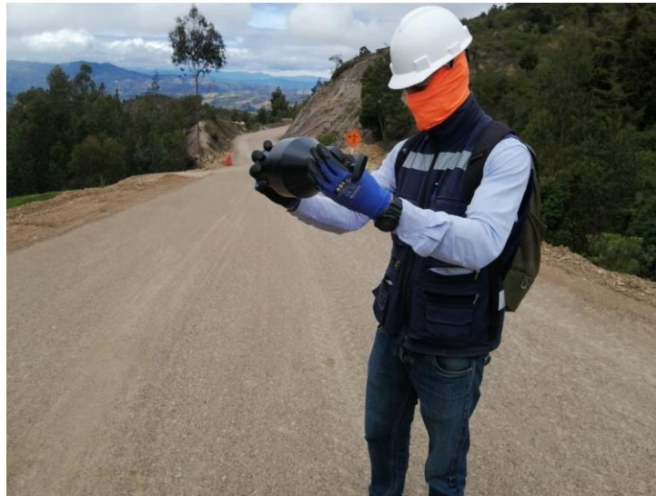
Ilustración 26. Toma densidades interventoría usando humedometro
