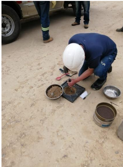
Ilustración 22. Toma de densidades (método del cono) contratistas
