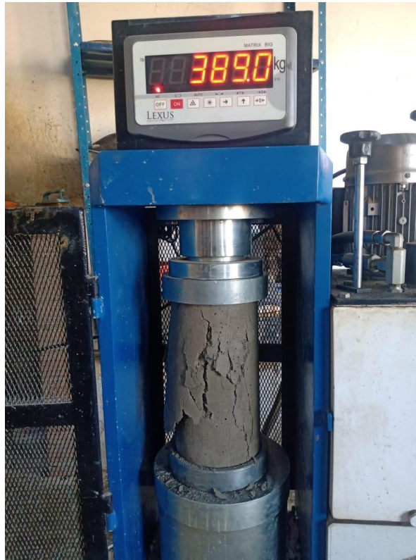
Ilustración 35. Fallo de cilindro en laboratorio
