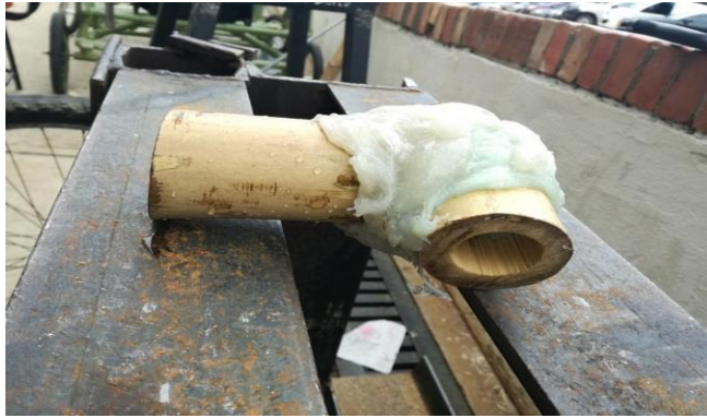
Figura 8. Prueba de unión polímero-guadua. Fuente: Los autores.
