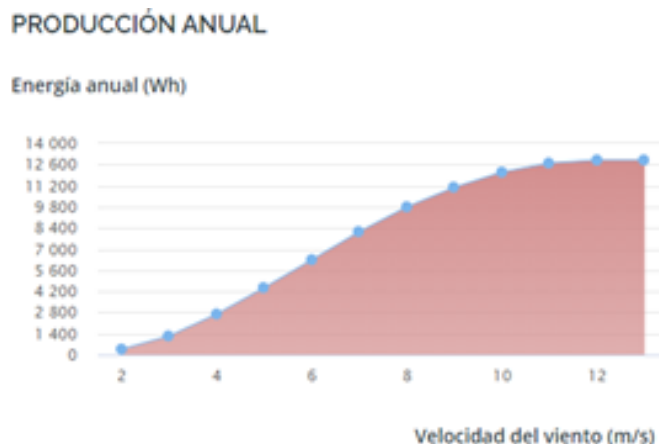
Fig. 3 Curva de producción energética anual, Aerogenerador de minieólica E 30 PRO. Fuente: https://www.enair.es/es/aerogeneradores/e30pro
