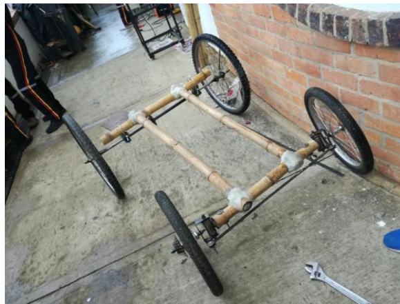
Figura 9. Polímero fundido usado en chasis de VTH. Fuente: Los autores.
