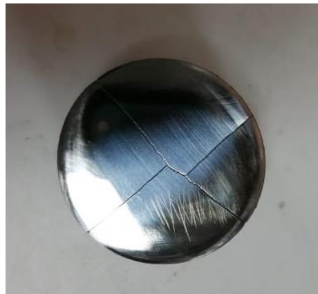
Fig. 17 Probeta de acero 8620 fracturada por el temple en agua. Fuente: Autores
