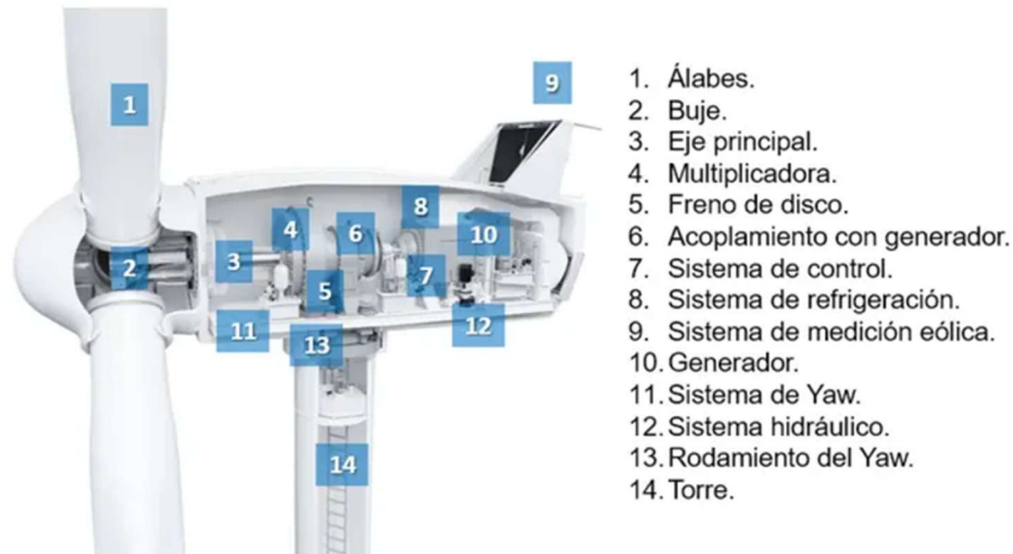
Figura 2. Aerogenerador y sus diversos componentes,
