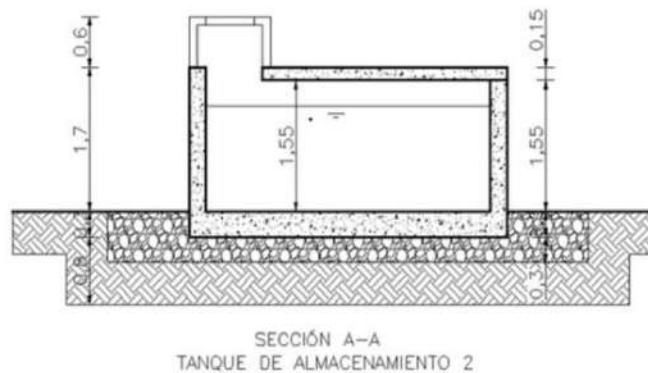
Figura 40. Planta general, tanque de almacenamiento 2.
