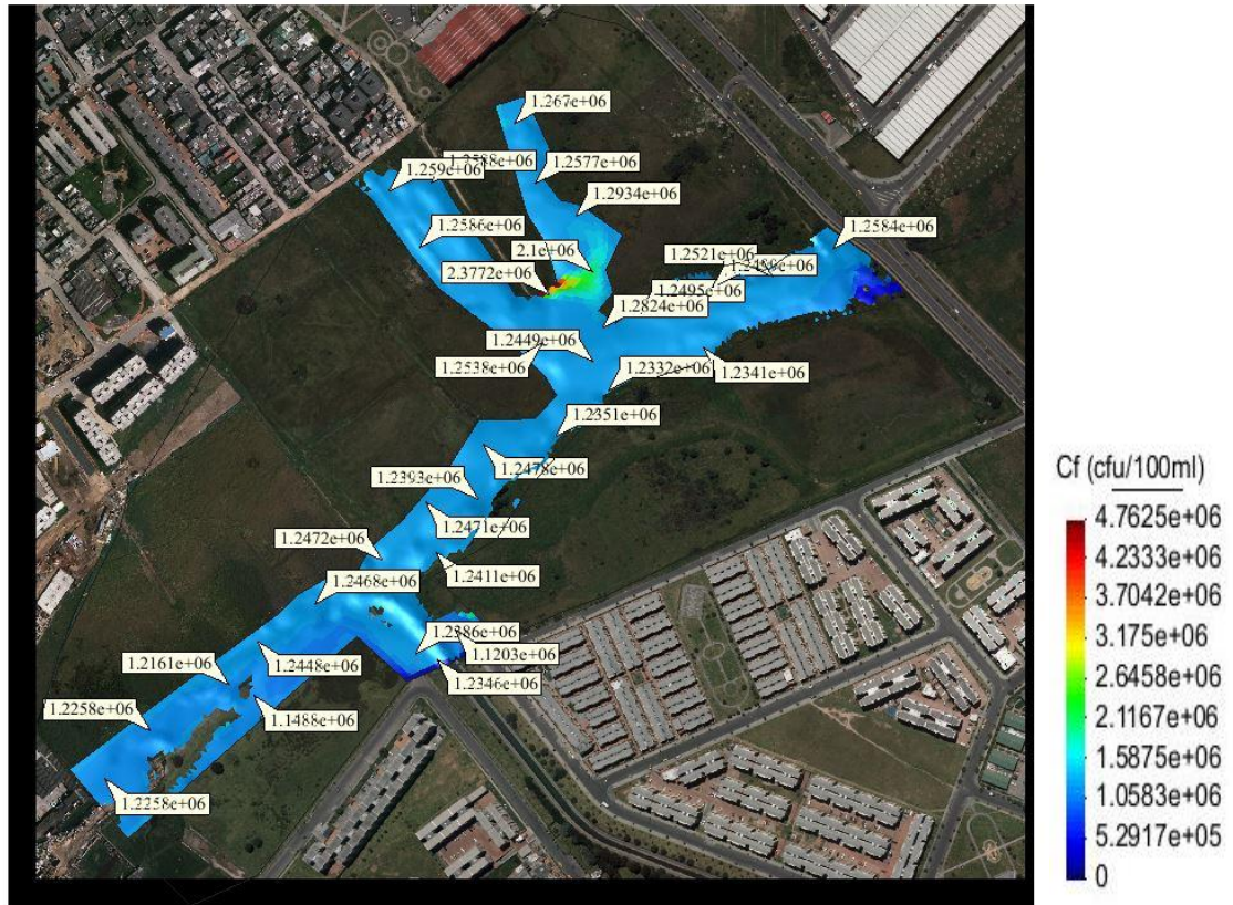
Figura 22. Coliformes para el escenario de periodo de retorno de 100 años para el Humedal Capellanía. Fuente: Autores.
