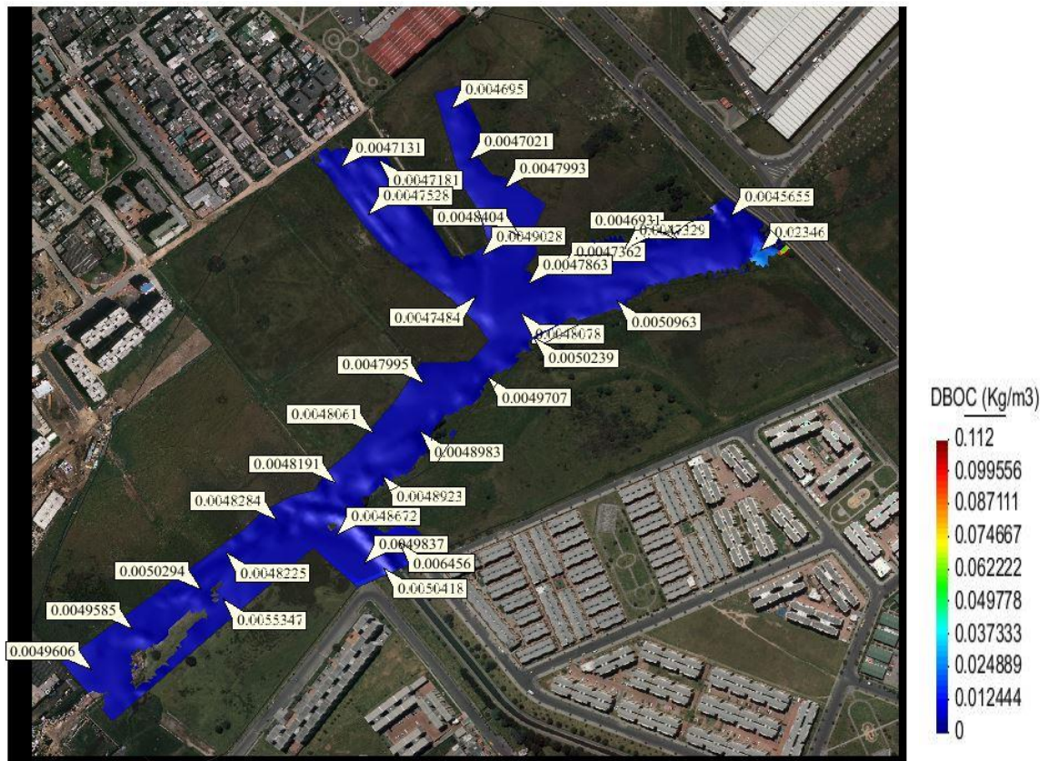
Figura 19. DBO para el escenario de periodo de retorno de 100 años para el Humedal Capellanía. Fuente: Autores.
