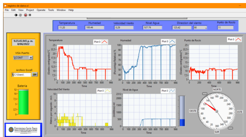
FIGURA 36: INTERFACE LABVIEW CON ADQUISICIÓN DE MUESTRAS
