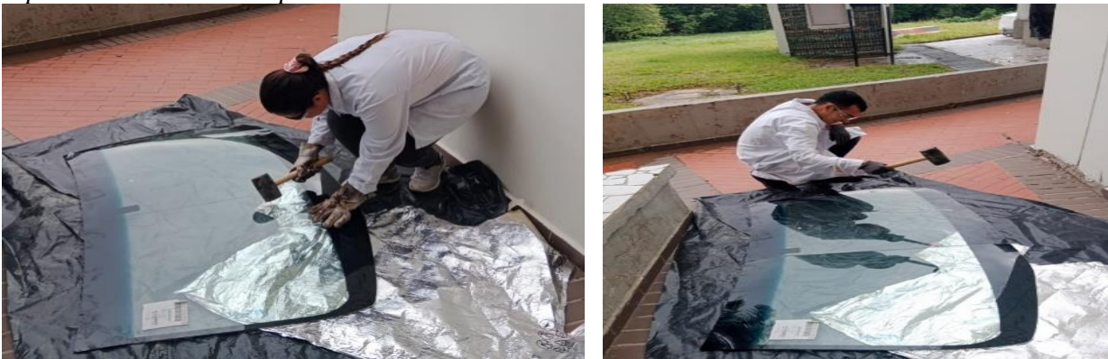
Figura 6. Preparación del vidrio templado molido
