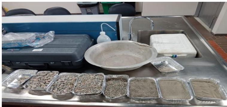
Figura 10. Material granular tamizado y clasificado.
