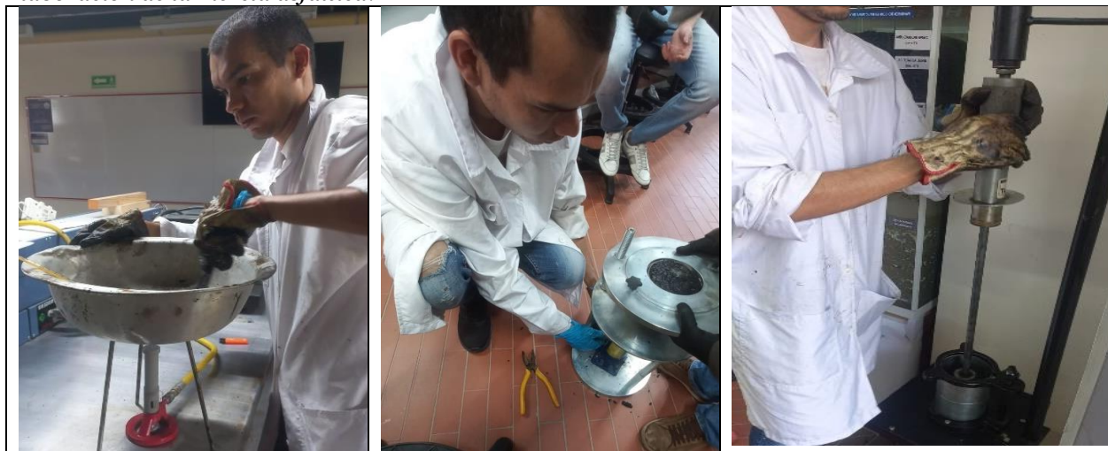
Figura 15. Elaboración de la mezcla asfáltica.
