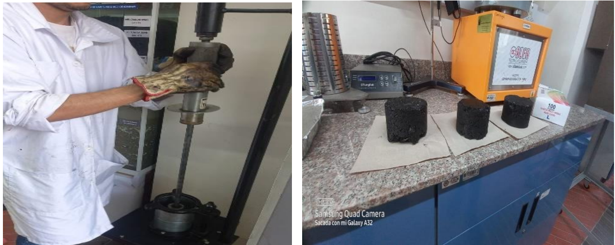
Figura 16. Elaboración de las briquetas
