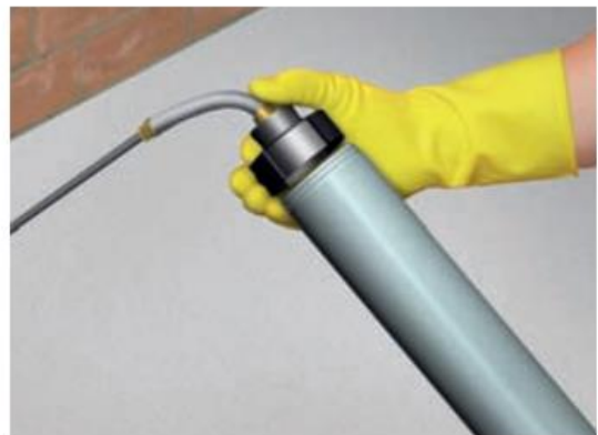
Enroscar de nuevo el tubo al final de la pistola
