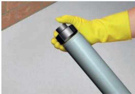
Desenroscar y quitar el tubo del final de la pistola
