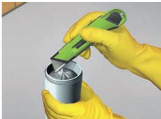
Cortar el extremo del salchichón SikaMur®-InjectoCream-100
