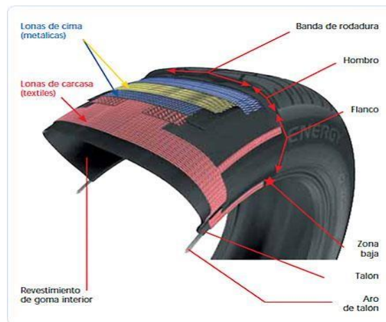
Figura 5. Partes de las llantas. Partes de un Neumático. Adoptado de (Menacho, 2018) por Saraza, 2019.
