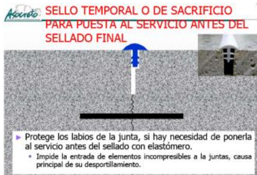
Figura 21. Esquema de protección de juntas. Fuente: ASOCRETO.
