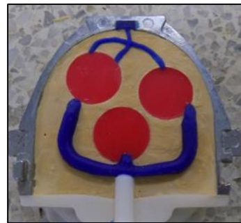
Imagen 3. colocación de los bebederos
