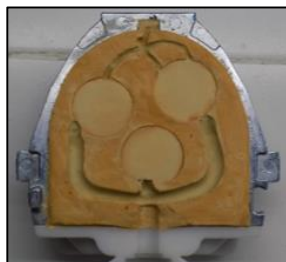
Imagen 4. Aplicación de separador para yeso
