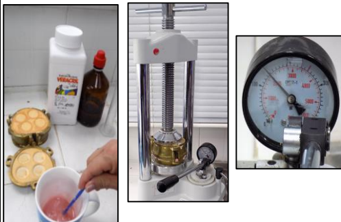
Imagen 4. Preparación del acrílico y prensado en la mufla
