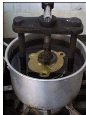
Imagen 5. Termopolimerización del acrílico por 1 hora
