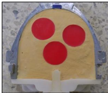
Imagen 4. Aplicación de separador para yeso
