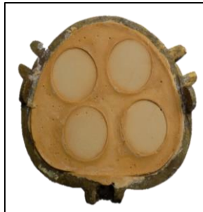
Imagen 5. Termopolimerización del acrílico por 1 hora
