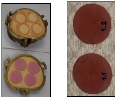
Imagen 6. Retiro de excesos y pulido de los discos acrílicos
