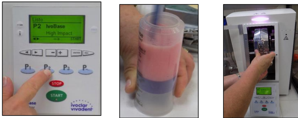
Imagen 6. Mezcla de la cápsula dosificadora. Elección del programa a utilizar y colocación de la mufla en la máquina de inyección
