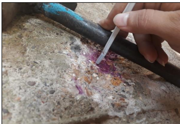
Figura 22 Paso 2 ensayo de la fenolftaleína Fuente: elaborado por el autor
