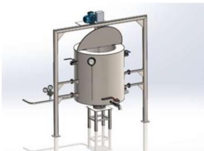
Figura 10 Opciones de diseño de una marmita fija. Autoría propia.
