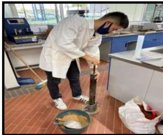
Figura 41 Procedimiento de la compactación
