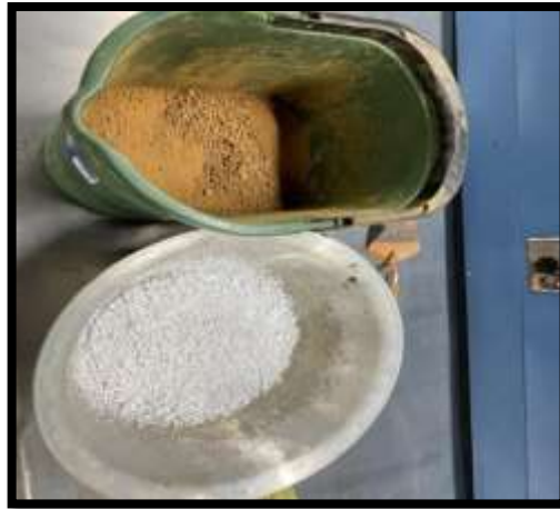
Figura 51 Muestra de suelo y pet necesarios para la elaboración del 2° espécimen
