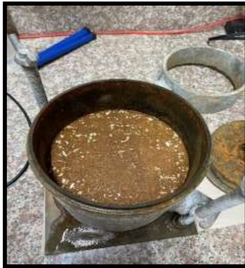
Figura 54 Suelo al 50% pet compactado después de la inmersión.
