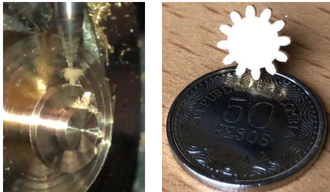
Figura 23. Izquierda, microengranaje. Derecha, microengranaje de módulo 0.6.
