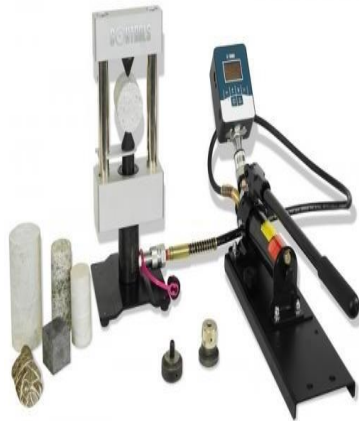
Figura 8. Equipo para ensayo de carga puntual Marca ControlsGroup.
