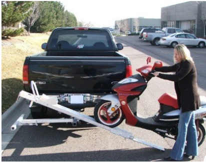
Imagen 7, Alternativa N°2, Sistema de transporte de Motocicletas para Camioneta con tiro de arrastre.
