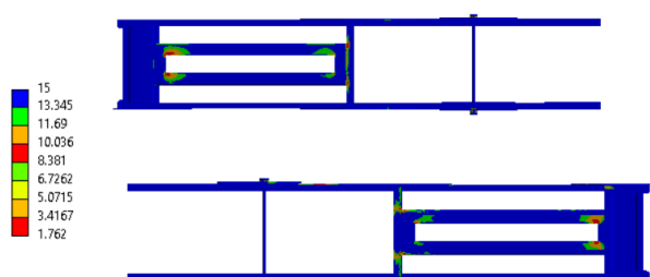
Imagen 34, Resultado simulación factor de seguridad vista superior / vista inferior
