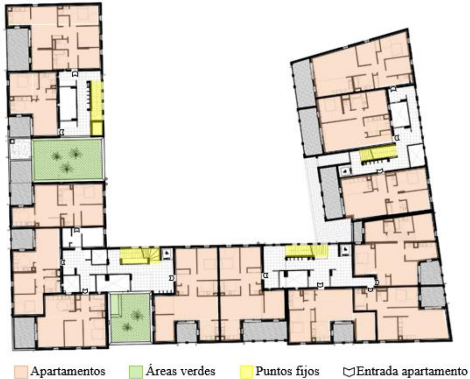
Figura 20. Zonificación planta edificio Antibes
