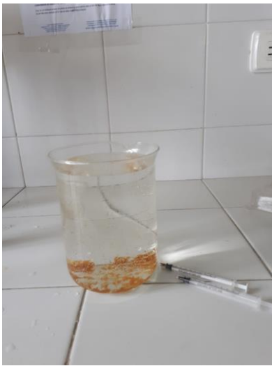
Ilustración 20 Flocs formados con cloruro férrico en planta
