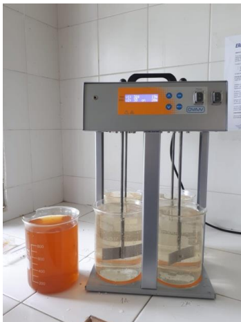
Ilustración 17 Equipo de ensayo de jarras en planta (Fuente Propia)
