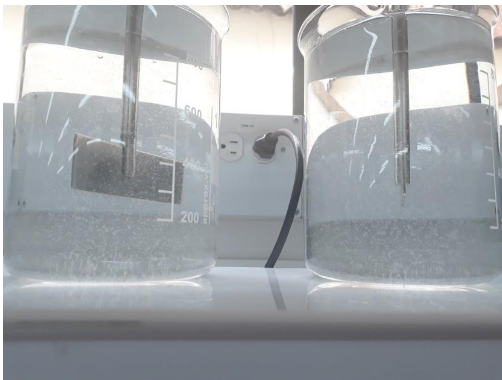
Ilustración 22: Flocs formador por sulfato de aluminio
