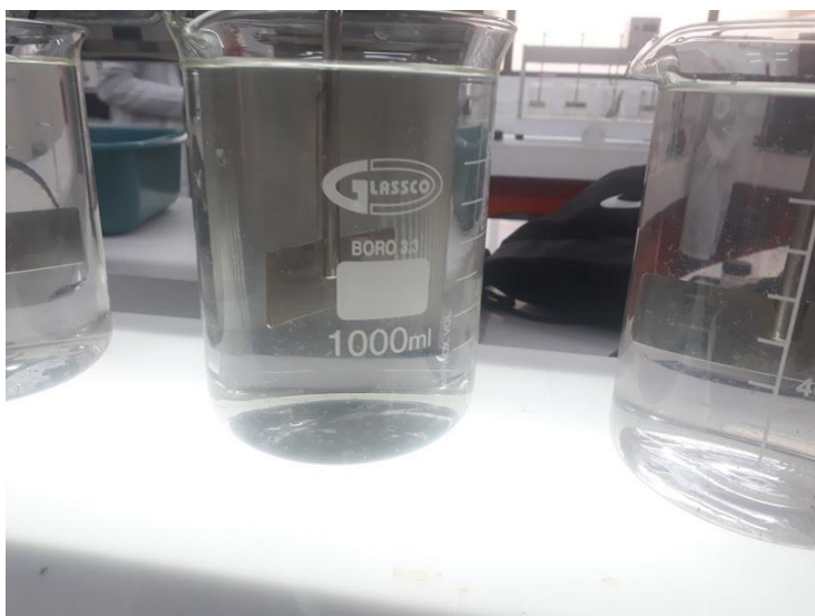
Ilustración 24 flocs formados con sulfato ferroso en laboratorios universitarios
