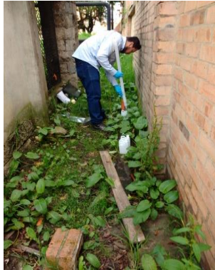
Fotografía 5 muestreo de agua subterránea
