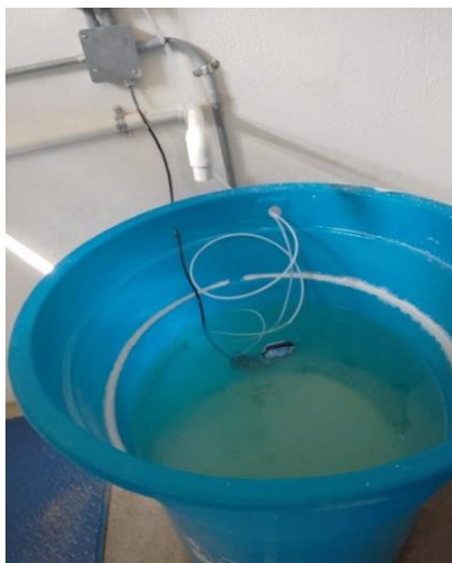
Figura N° 7. tanque dosificador con sonda para hacer succión del desinfectante
