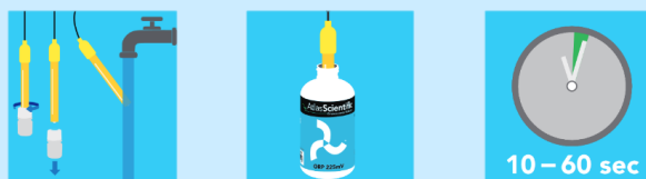
Figura 21. Proceso de calibración sonda ORP [6].
