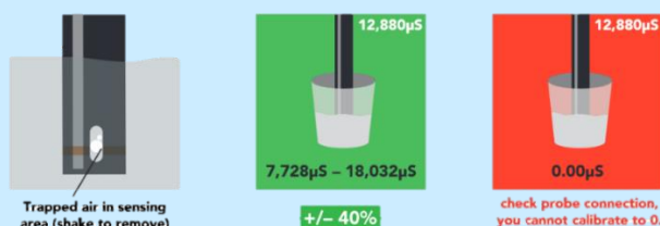
Figura 22. Proceso calibración sonda EC [7].
