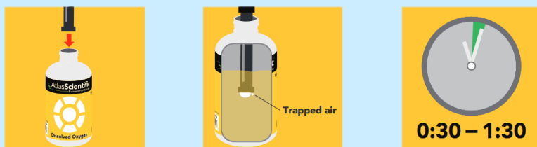
Figura 23. Proceso calibración sonda DO [8].
