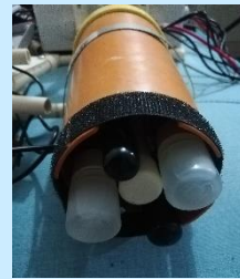
Figura 2. Caja de componentes electrónicos y sondas de los sensores.
