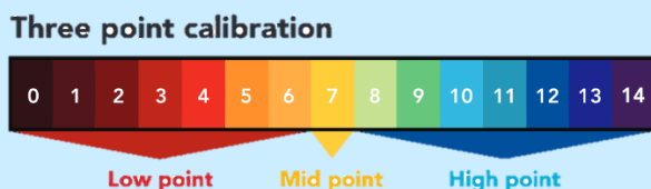
Figura 20. Rango pH con los puntos de calibración [5].
