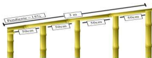
Figura 12. Diseño de pasamanos en guadua. por Agudelo & Riobueno, 2019.
