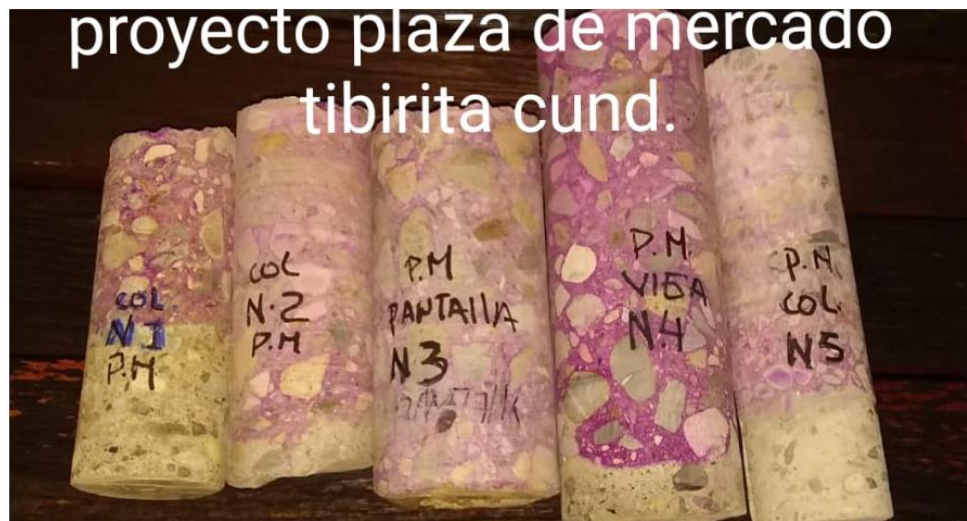
Fotografía 23. Medición de carbonatación – Columna 1, Columna 2, Columna 3, Pantalla y Viga
