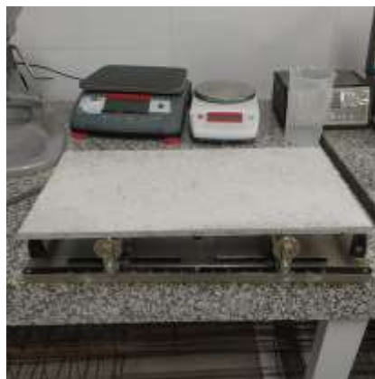
Imagen 18: Comprobación del tamaño de los apoyos.
