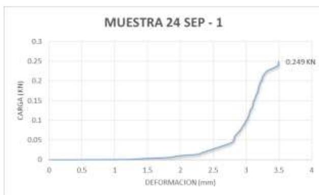
Imagen 34: Gráfica Carga vs Deformación.
