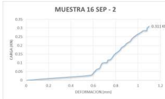
Imagen 40: Gráfica Carga vs Deformación.
