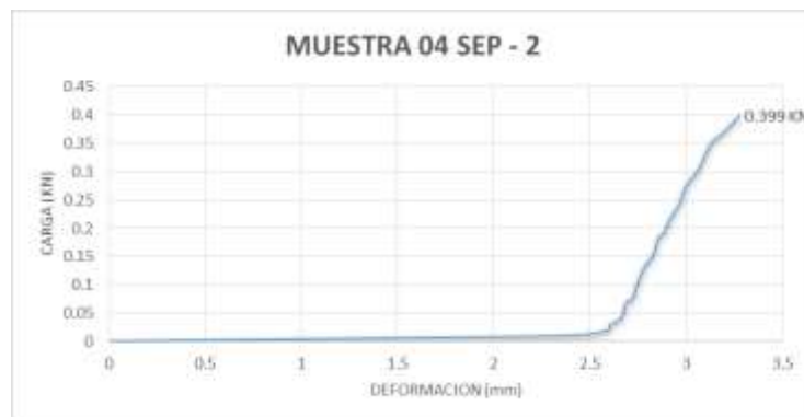
Imagen 44: Gráfica Carga vs Deformación.
