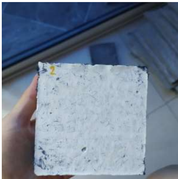
Imagen 10: Cara 2 mezcla cemento blanco y residuo textil.
