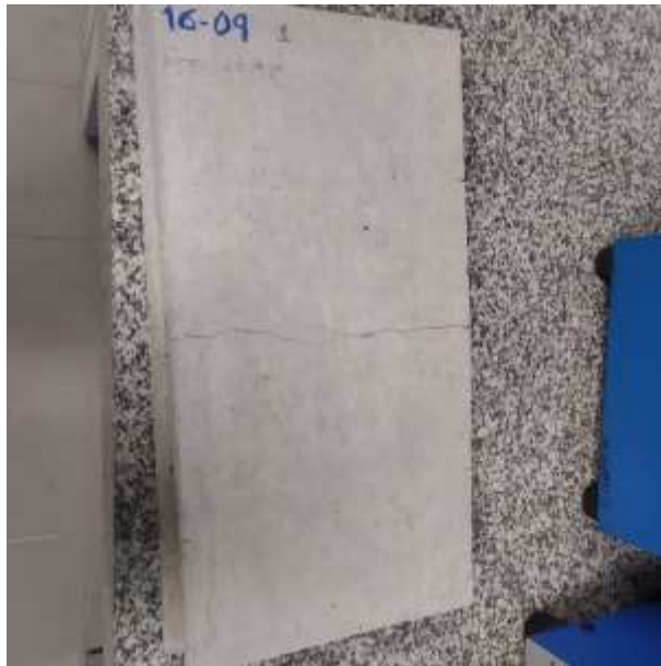
Imagen 37: Aparición de la grieta después de fallada.
