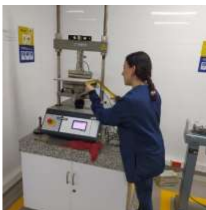
Imagen 19: Comprobación de las medidas de los puntos de apoyo.
