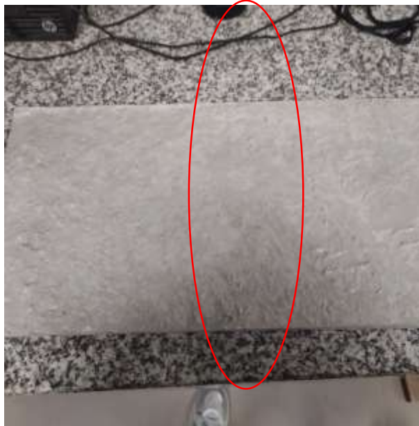
Imagen 25: Aparición de grieta después de fallada.
