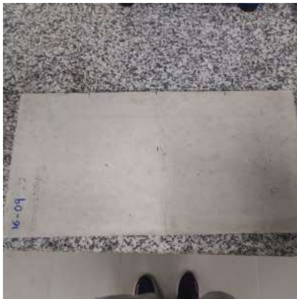
Imagen 39: Aparición de grieta después de la falla.
