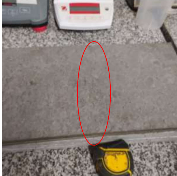
Imagen 29: Grieta del resultado de la falla.
