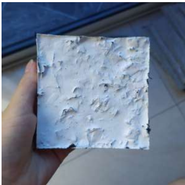
Imagen 9: Cara 1 mezcla cemento blanco y residuo textil.
