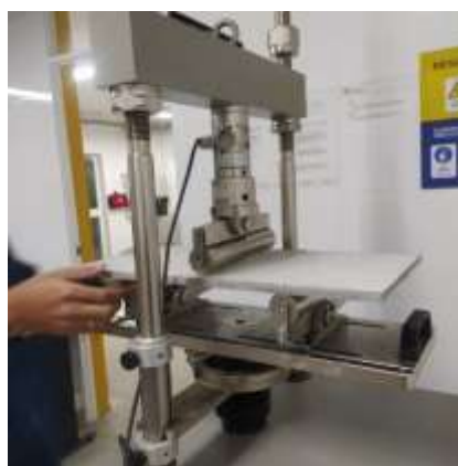
Imagen 20: Panel listo para fallar.
