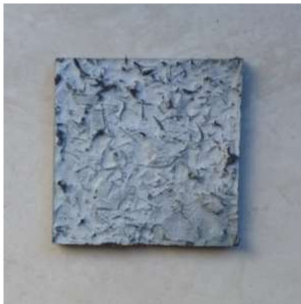
Imagen 15: Cara 20% residuo y 80% cemento.
