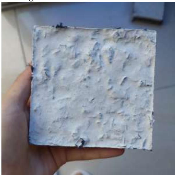
Imagen 11: Cara 1 mezcla yeso y residuo textil.
