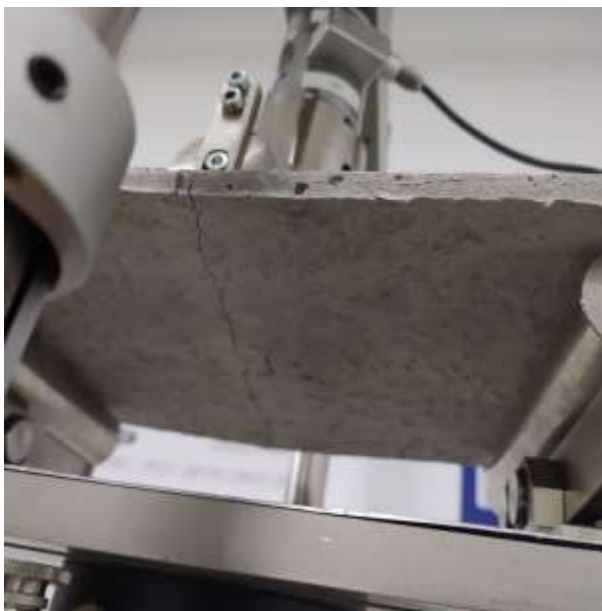
Imagen 21: Visualización de la falla.
