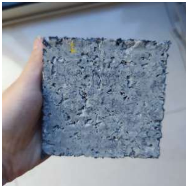
Imagen 8: Cara 2 mezcla de cemento y residuo textil.
