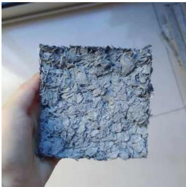
Imagen 7: Cara 1 mezcla cemento y residuo textil.
