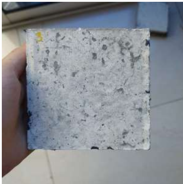
Imagen 12: Cara 2 mezcla yeso y residuo textil.
