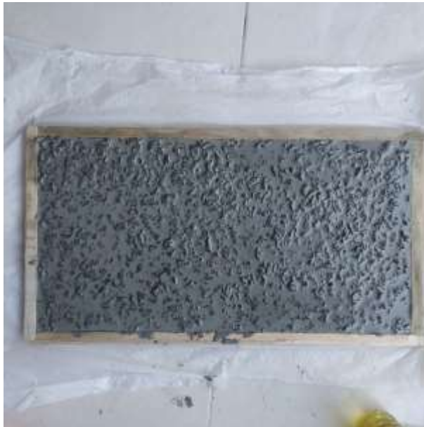
Imagen 6: Mezcla recién vertida en el molde.
