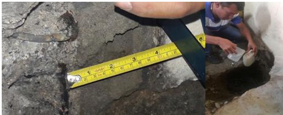
Ilustración 37 Toma de muestra y revisión de columna objeto de ensayo (Fuente. Los Autores)
