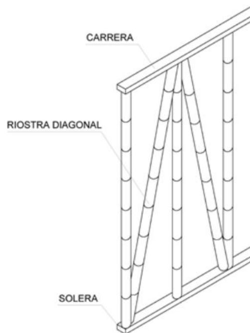
Figura 41. Muro estructural con diagonales
