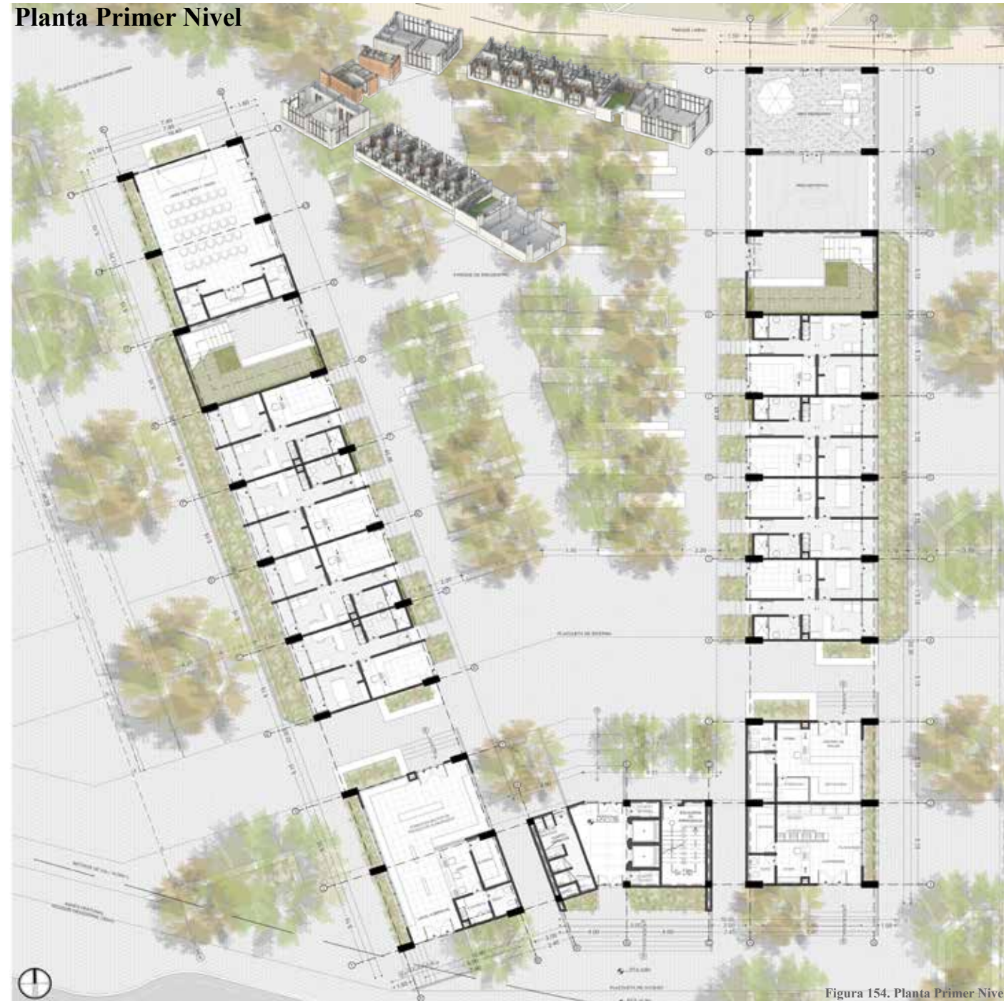
Figura 154. Planta Primer Nivel
