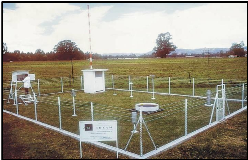
Fig. 18 Instalacion de una estación hidrometeorológica ordinaria
