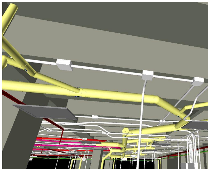
Figura 32. Red aguas negras y red de iluminación
