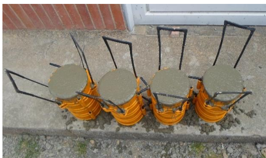
Imagen 11. Toma de muestras de concreto mediante cilindros
