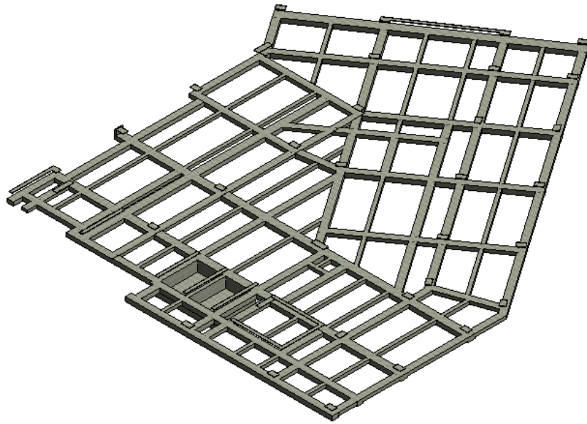
Figura 3. Vigas de cimentación
