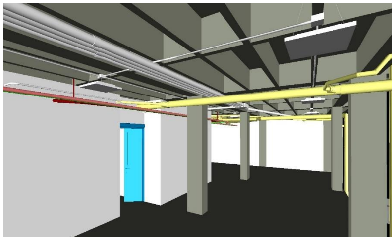
Figura 31. Salida de colector de red aguas negras y parciales en piso 1
