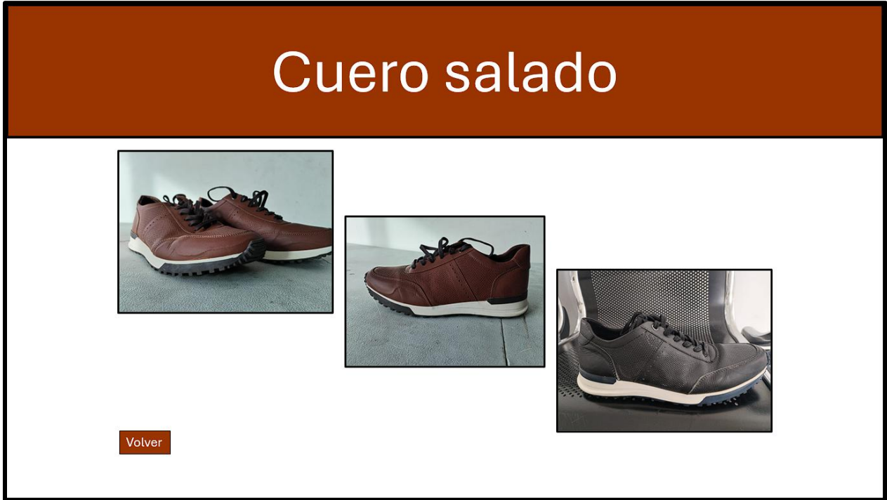
Figura 10. Ejemplo de defecto de Cuero salado.
