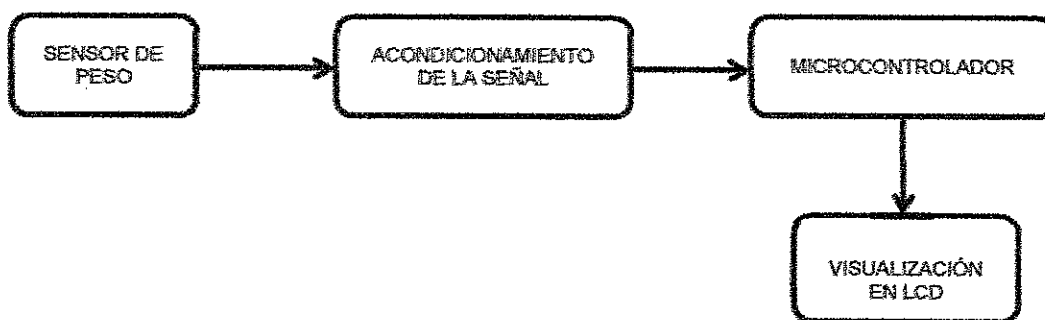
Figura 41. Diagrama de bloques eléctrico Fuente: Autores
