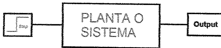
Figura 44. Sistema a lazo abierto Fuente: Autores
