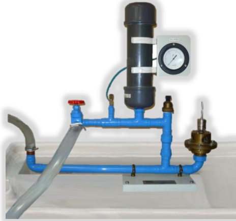
Fig. 1 Montaje experimental de la bomba de ariete
