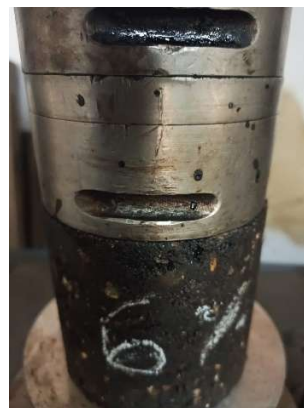
Fotografía 28. Probeta 6% de emulsión.
