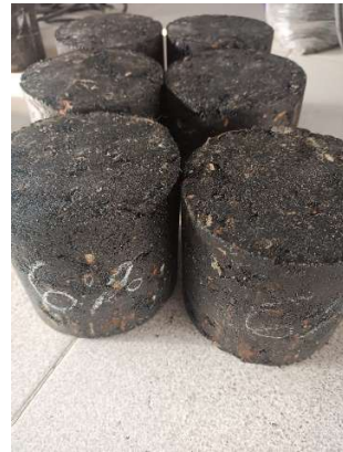
Fotografía 20. Probetas elaboradas 6% de emulsión.
