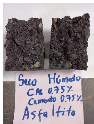
Fotografía 48. Probeta abierta luego del ensayo.
