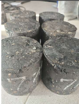
Fotografía 21. Probetas elaboradas 7% de emulsión.
