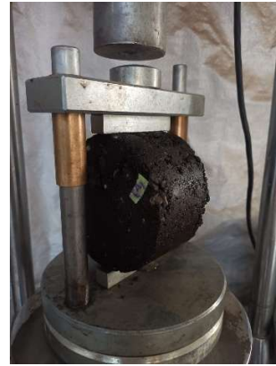
Fotografía 44. Probeta sometida al ensayo de tracción indirecta.
