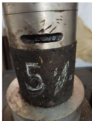
Fotografía 27. Probeta 5% de emulsión.
