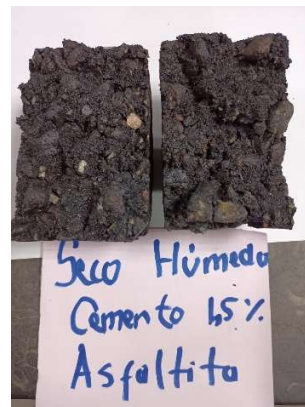
Fotografía 46. Probeta abierta luego del ensayo.
