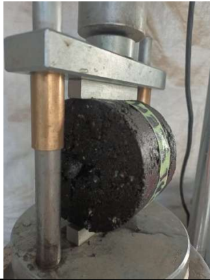
Fotografía 43. Probeta sometida al ensayo de tracción indirecta.
