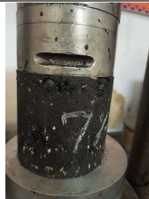
Fotografía 30. Probeta 7% de emulsión.
