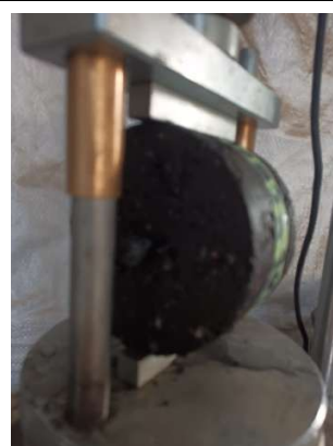
Fotografía 40. Probeta sometida al ensayo de tracción indirecta.
