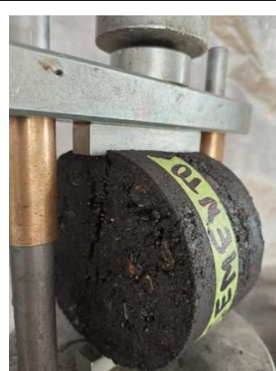
Fotografía 42. Probeta sometida al ensayo de tracción indirecta.
