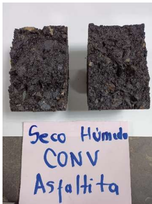
Fotografía 45. Probeta abierta luego del ensayo.
