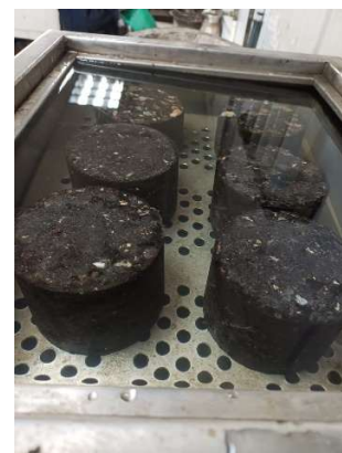
Fotografía 24. Inmersión de las probetas en agua.
