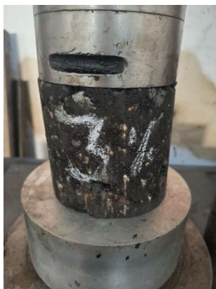
Fotografía 25. Probeta 3% de emulsión.
