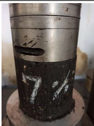
Fotografía 29. Probeta 7% de emulsión.
