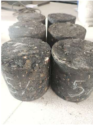
Fotografía 19. Probetas elaboradas 5% de emulsión.
