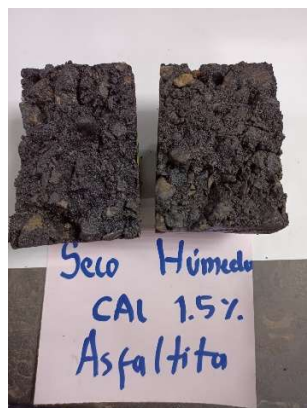
Fotografía 47. Probeta abierta luego del ensayo.
