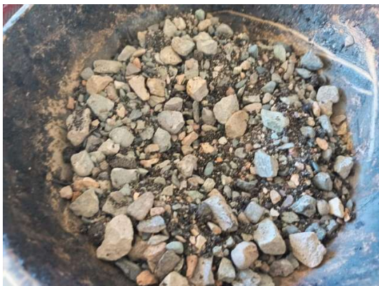
Fotografía 11. Mezcla de asfaltita más agregados adicionados.
