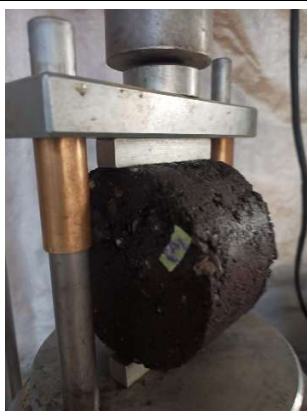
Fotografía 41. Probeta sometida al ensayo de tracción indirecta.
