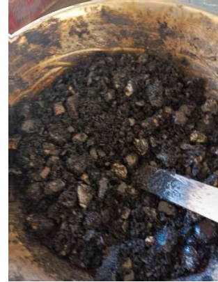
Fotografía 14. Mezcla de asfaltita más agregados y emulsión.
