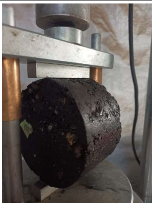
Fotografía 39. Probeta sometida al ensayo de tracción indirecta.
