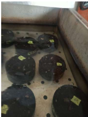
Fotografía 37. Acondicionamiento de los especímenes saturados.
