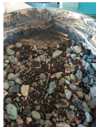
Fotografía 12. Mezcla de asfaltita más agregados adicionados.
