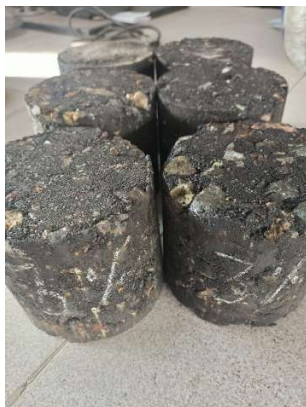
Fotografía 17. Probetas elaboradas 3% de emulsión.
