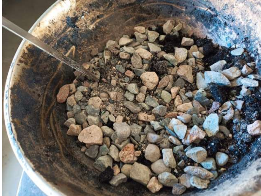
Fotografía 13. Mezcla de asfaltita más agregados adicionados.
