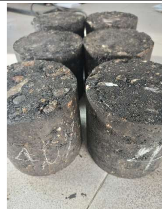
Fotografía 18. Probetas elaboradas 4% de emulsión.
