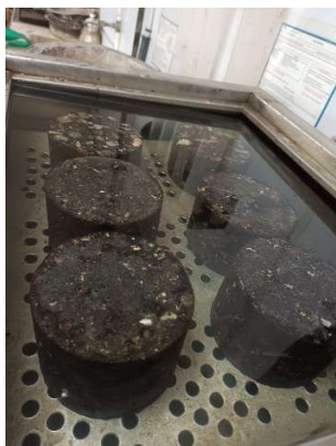
Fotografía 23. Inmersión de las probetas en agua.
