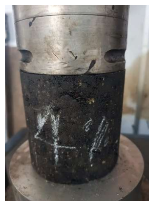
Fotografía 26. Probeta 4% de emulsión.
