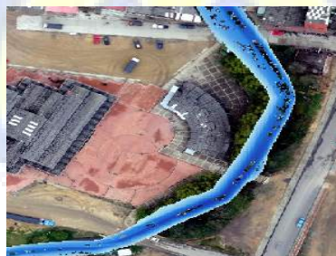
Imagen 15. Mancha de inundación zona 2 T=50 .
