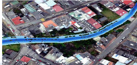
Imagen 13. Mancha de inundación zona 1 T=50 .
