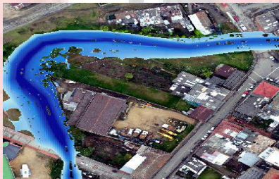
Imagen 14. Mancha de inundación zona 2 T=50 .
